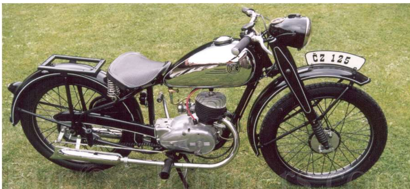
ČZ 125 T 1948 („T“ znamená teleskopickou vidlici)
