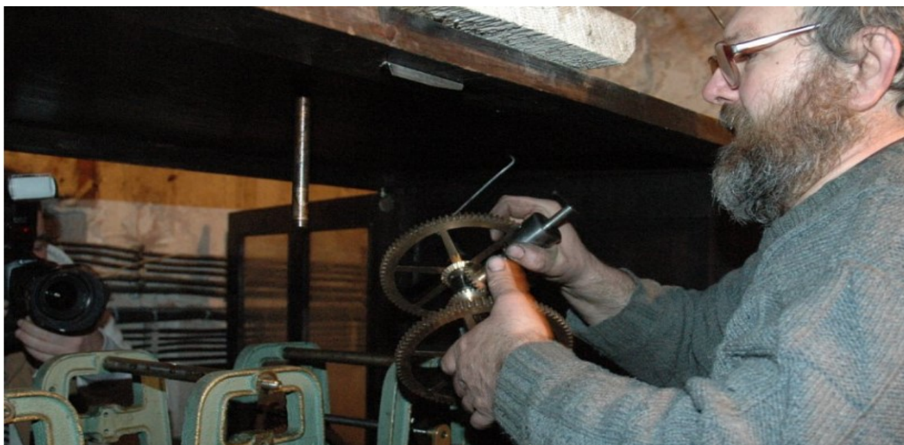
Pan Jiří Landa, mistr hodinář, montuje diferenciál do věžních hodin.
