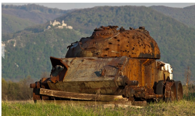
Pohyblivý letecký terč (vrak tanku, který se tahal na laně za jiným tankem)
